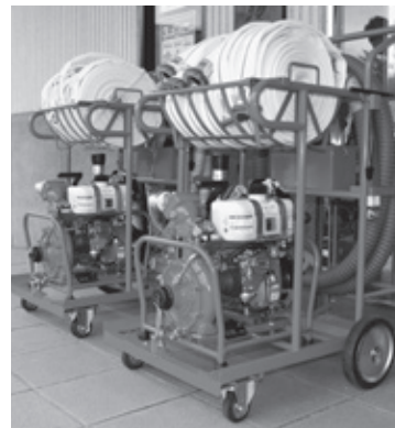
▲可搬式小型消防ポンプ
