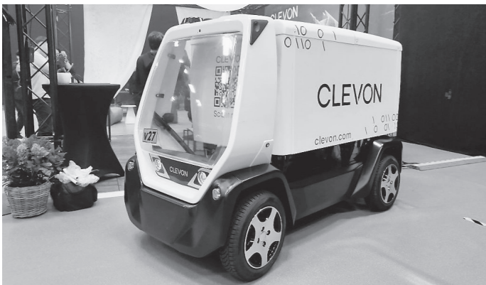
▲エストニアのロボティクス企業が開発した 中速中型自動配送ロボット「Clevon 1」
